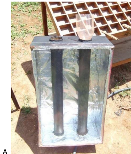
Figura 1 – Coletor solar (A), garrafas pet transparentes (B) e vasos de 4 L vedados com filme plástico.
